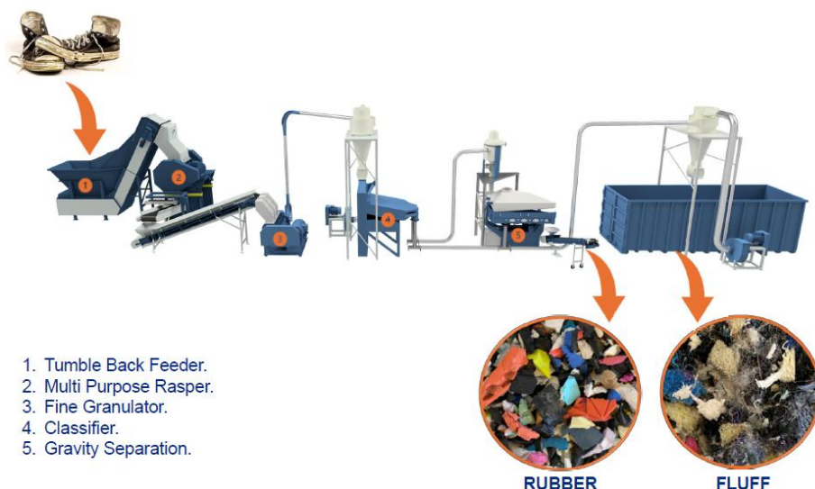
Figure 49 : Ligne de recyclage des chaussures
