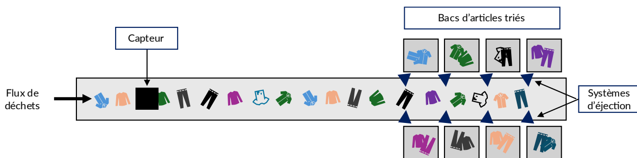
Figure 8: Schéma du fonctionnement d'une ligne de tri multi-catégories
